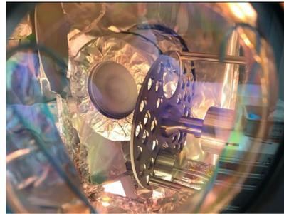
Zudem eröffnet sich in der Anwendung ein wichtiger zusätzlicher Freiheitsgrad für den Beschichtungsprozess: Dank der geregelten Kühlung bis 0°C werden Beschichtungen deutlich unterhalb der üblichen Sättigungstemperatur ermöglicht.
